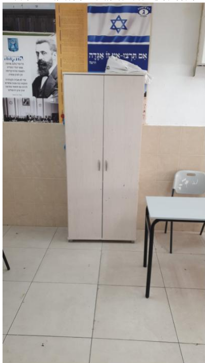
- ארונות, ספריות וכונייות יהיו מקובעים למניעת התהפכות-1-חדרים : 26 / 27 / 13 / 03 / מפגע גורף-. ארונות לא מקובעים- - - 5.5-28/1/2023 16:04 מופעים קבועים וניידים
